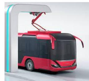
Abb. 11: Pantographenladen
